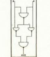
Tout comme avec le circuit simulé un OR, à partir de ce circuit il est aisé de concevoir un nouveau montage permettant d'opérer une fonction NXOR en ajoutant un NAND monté en inverseur à la sortie du circuit ci-dessus.
